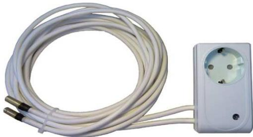
Diferencijalna automatika SA-S namjenjena je za upravljanje jednim krugom dogrijavanja (solar, kotao ili sl.) Izvedba u kućištu sa šuko utikačem i utičnicom omogućava izuzetno jednostavnu ugradnju. Dvije signalne lampice omogućavaju provjeru stanja izlaza za pumpu i očitanje temperatura oba senzora. Automatika je tvornički predprogramirana tako da je vrijeme potrebno za instalaciju svedeno na minimum.
